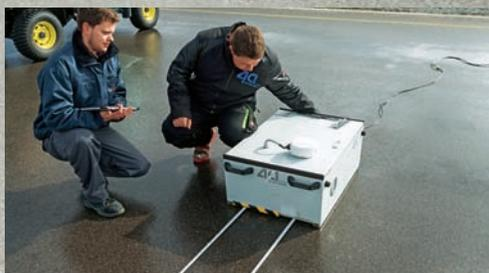
Über die GPS-Antenne am Dach wird die Geschwindigkeit des Testwagens ermittelt
